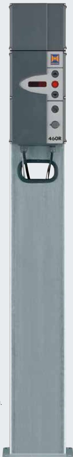
Opcional: Columna de soporte STI 1 Para el montaje de máx. 2 cuadros de maniobra con carcasa adicional. Color: Aluminio blanco RAL 9006 Medidas: 200 x 60 mm, Alto 1660 mm
