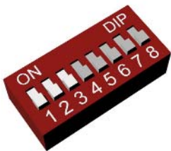
S1 OFF S2 OFF S3 OFF Configuración Hoja simple (Default - No MULTISLAVE )
