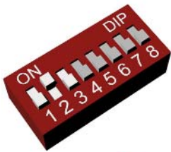
S1 OFF S2 ON S3 OFF Configuración Hoja simple MULTISLAVE - dirección 2
